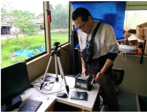
(Membersihkan roller dan head print printer cetak SIM)
